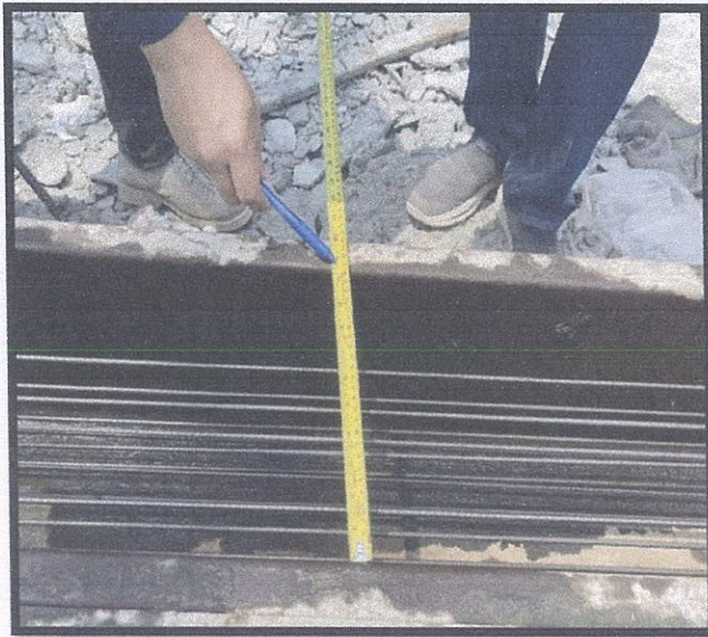
ภาพถ่าย ขั้นตอนการตรวจสอบโรงงานผลิตเสาเข็ม ค.ส.ล.ขนาด 0.26 x 0.26 เมตร
